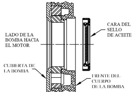
Coloque la carcasa de la bomba sobre una superficie plana y sólida. Coloque el Retén, como se muestra arriba, con el sello de aceite hacia afuera. Aplique una capa fina de aceite sobre el diámetro exterior del retén. Utilice una herramienta de instalación que aplique la fuerza sobre toda la superficie del retén. Tenga cuidado de no instalar el retén inclinado o chueco. No golpee directamente sobre el retén. Presione el retén hasta que quede al ras del borde del cuerpo de la bomba.
